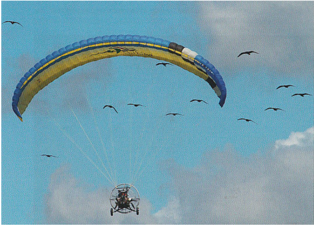
Das Ultraleichtflugzeug ist ein Paragleiter mit hinten angebrachtem Propellermotor. Der Pilot liegt offen im Sitz, in Kontakt mit den Waldkrappen.
